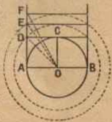
déterminé D, OE est le rayon du cercle qui a une aire triple de celle du cercle donné car  $\overline{OE}^2 = \overline{OA}^2 + \overline{AE}^2$ .
